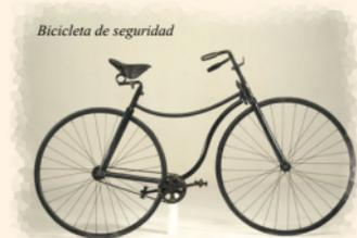
Posteriormente *John Kemp Starley* acopló los frenos, para una mayor seguridad, y usó los rodamientos, añadiéndose poco después los neumáticos desarrollados por *John*
