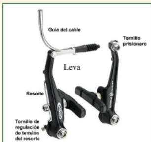
tenso y si las zapatas están en buen estado. Los regularemos de tal manera que al apretar el freno, los dos lados de la leva estén a la misma distancia de la llanta (en los frenos en V). Si roza hay que regular la zapata
